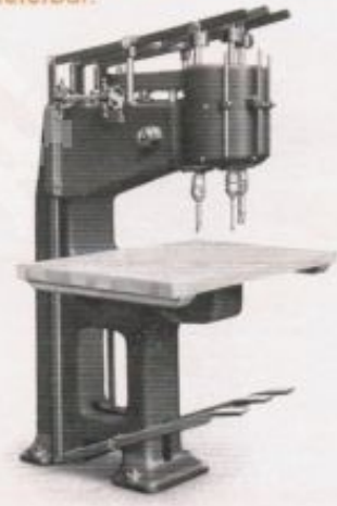
AS 7 KLFM Kombinierte Elektro-Schnellläufer-Bandsäge mit Fräse, Kreissäge und Langlochbohrvorrichtung. Auch nur mit Fräse lieferbar.
