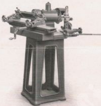
XTM Elektro-Patent-Handscheifmaschine Der „Elektro-Holzschleifhobel“ für furnierte Flächen. Geeignet zum Abzählen und Gratfräsen. Auch mit Ast- lochbohrapparat u. Fischbänder-Einlaß-Apparat lieferbar.
